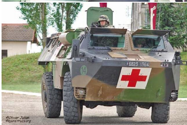
Véhicule de l'avant blindé équipé en version sanitaire
